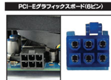
グラフィックスボード側の電源コネクタが6ピンの場合
